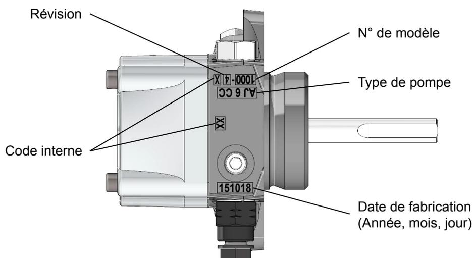
Les données correspondant à la configuration de l'installation (monotube ou bitube) ne sont pas gravées sur la pompe car ce paramètre peut être modifié lors de la mise en service.
