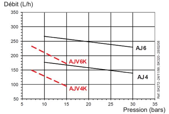
Viscosité = — 5 cSt - Vitesse de rotation = 2850 t/min
