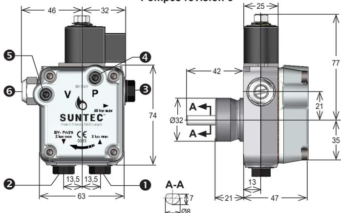
Arrivée ① et retour ② avec étanchéité directe pour les modèles révision 6 (l'étanchéité avec rondelle sur lamage reste possible)
