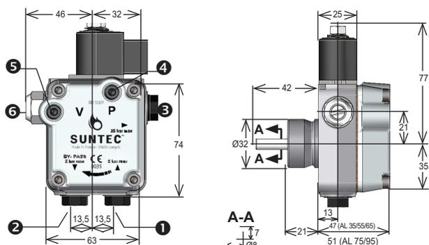
Arrivée ① et retour ② avec étanchéité directe pour les modèles révision 6 (l'étanchéité avec rondelle sur lamage reste possible)
