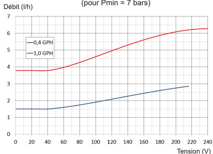
Viscosité = 5 cSt - Vitesse de rotation = 2850 tr/min
