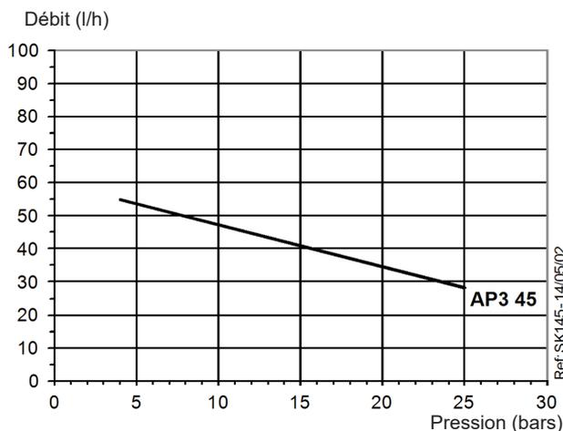
Viscosité = 5 cSt - Vitesse de rotation = 2850 t/min
