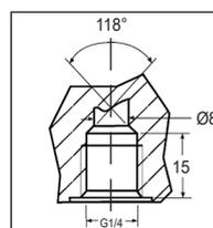
Arrivée ① et retour ② avec étanchéité directe pour les modèles révision 6 (l'étanchéité avec rondelle sur lamage reste possible)
