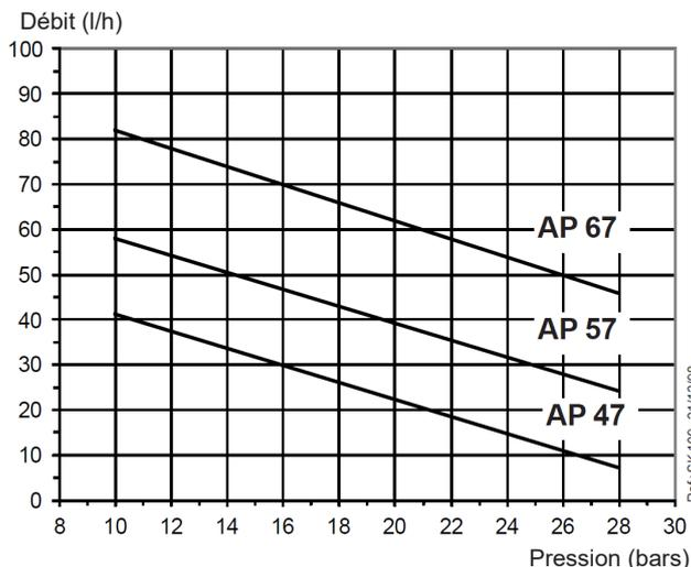
Viscosité = 5 cSt - Vitesse de rotation = 2850 t/min
