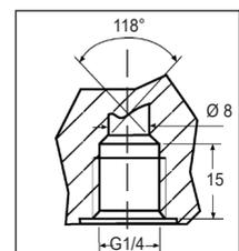
Arrivée 1 et retour 2 avec étanchéité directe pour les modèles révision 6 (l'étanchéité avec rondelle sur lamage reste possible)
