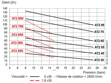
Les caractéristiques indiquées tiennent compte d'une marge d'usure. Ne pas sur-dimensionner les pompes lors du choix de la capacité d'engrenage afin d'assurer un fonctionnement optimum de l'électrovanne (NO) de changement d'allure.
