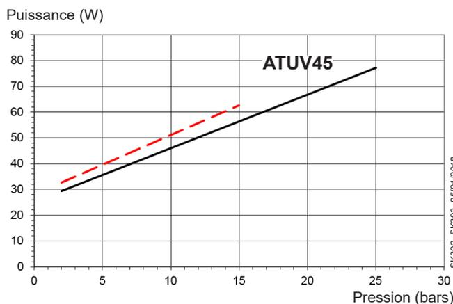
Viscosité = — 1,8 cSt Vitesse de rotation = 2850 tr/min
