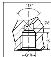
Arrivée ① et retour ② avec étanchéité directe (l'étanchéité avec rondelle sur lamage reste possible)
