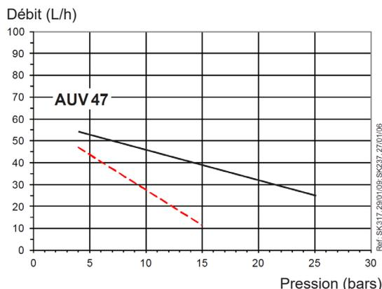
Viscosité = ——— 5 cSt - Vitesse de rotation = 2850 t/min
