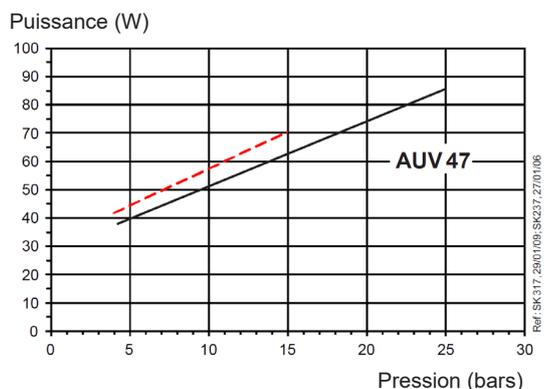
Viscosité = ——— 5 cSt - Vitesse de rotation = 2850 t/min
