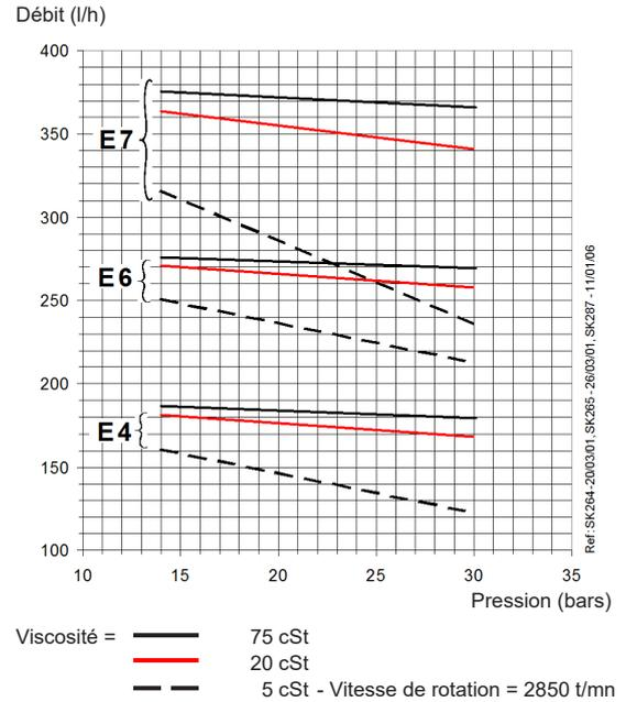
Les caractéristiques indiquées tiennent compte d'une marge d'usure. Ne pas sur-dimensionner les pompes lors du choix de la capacité d'engrenage.
