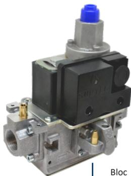
Bloc multifonctionnel gaz équipé de 2 électrovannes de sécurité Classe A (selon la norme EN 161) et d'un régulateur de pression sur la sortie (EN 88-1). Conçu pour les brûleurs gaz à air pulse et brûleurs gaz atmosphériques d'une puissance allant jusqu'à 450 kW. Disponible avec l'option ouverture lente.
