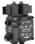
Cette pompe comporte deux sorties gicleur commandées par deux électrovannes de coupure (conformes à DIN EN ISO23553-1) intégrées et indépendantes. Un seul régulateur délivre une pression identique dans les deux lignes gicleur.
