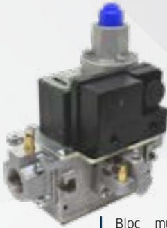
Bloc multifonctionnel gaz équipé de 2 électrovannes de sécurité Classe A (selon la norme EN 161) et d'un régulateur de pression sur la sortie (EN 88-1). Conçu pour les brûleurs gaz à air pulse et brûleurs gaz atmosphériques d'une puissance allant jusqu'à 500 kW. Disponible avec l'option ouverture lente.
