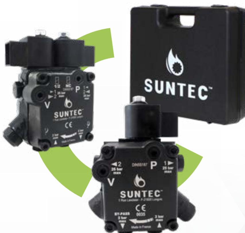
Ces deux modèles de pompe à fioul SUNTEC **AUV** sont spécialement destinés au marché de remplacement: ils remplacent la majorité des pompes une allure du marché, dont la plupart des références SUNTEC AS 47,AL 35, ALE 35. Ils comportent une électrovanne en ligne avec clapet de retour assurant la fonction de coupure et permettant la décharge de la ligne gicleur. Ils disposent de deux sorties gicleur possibles.
