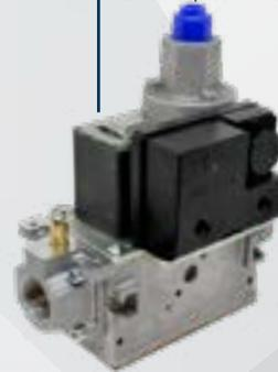
Bloc combiné gaz équipé de 2 électrovannes de sécurité Classe A (selon la norme EN 161) sans régulateur gaz. Conçu pour les brûleurs gaz à air pulse et brûleurs gaz atmosphériques d'une puissance allant jusqu'à 650 kW. Disponible avec l'option ouverture lente.
