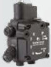
Cette pompe comporte deux sorties gicleur commandées par deux électrovannes de coupure (conformes à DIN EN ISO23553-1) intégrées et indépendantes. Un seul régulateur délivre une pression identique dans les deux lignes gicleur.
